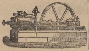
Máquina de vapor fija horizontal
