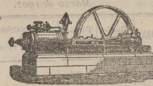
Máquina de vapor fija horizontal
