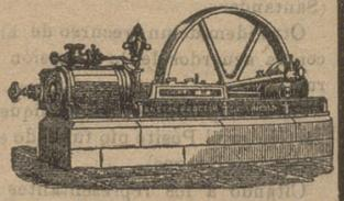
Máquina de vapor fija horizontal
