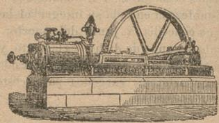
Máquina de vapor fija horizontal.
