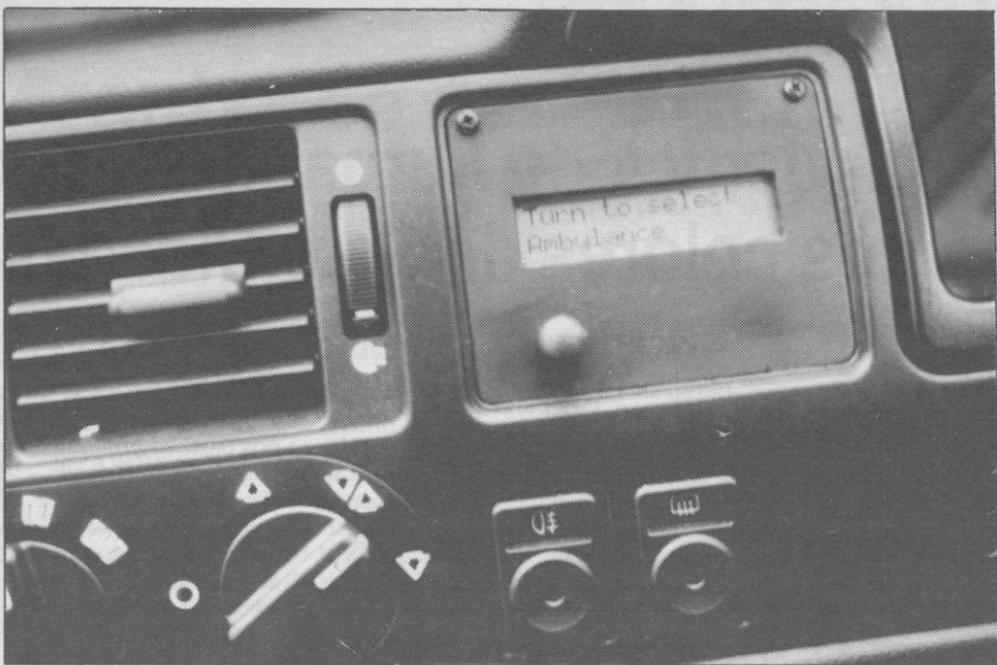
Pantalla para el sistema automático de emergencia.
