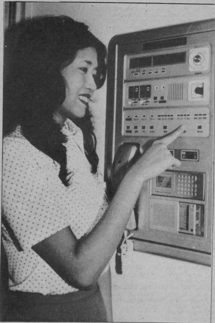
Este equipo informático instalado en un hogar controla todos los electrodomésticos y actúa como alarma en caso de incendio, escape de gas o intento de robo. Es la primera generación de los llamados robots del hogar.—(Foto EFE)
