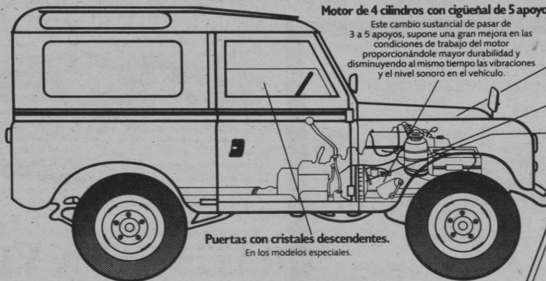
**Motor de 4 cilindros con cigüeñal de 5 apoyos.**
