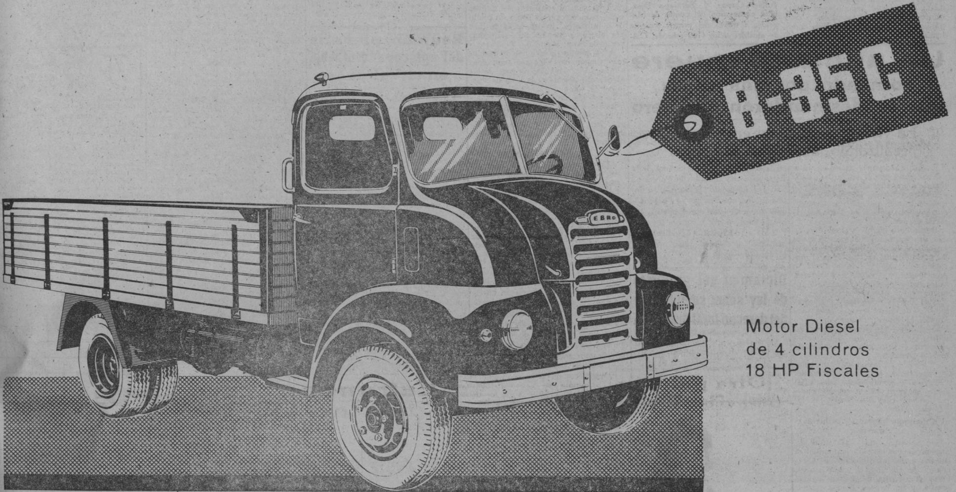
Motor Diesel de 4 cilindros 18 HP Fiscales
