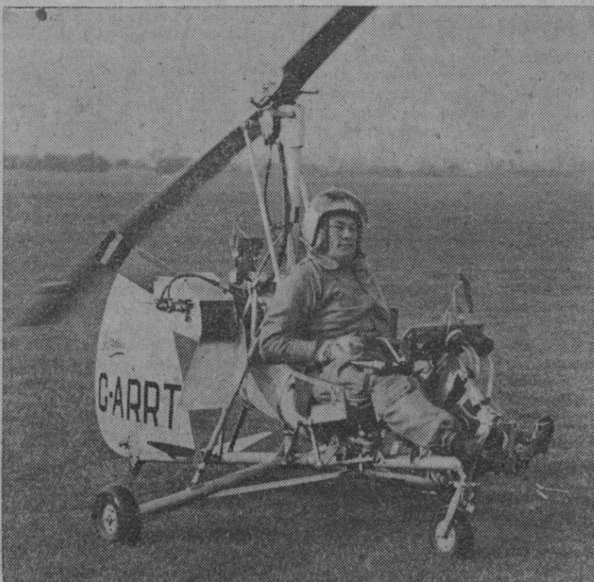
Tres de estos autogiros Beagle-Wallis WA 116, monoplazas, serán entregados este año al Ejército británico para un programa de pruebas y ejercicios militares. Propulsado por un motor de 70 h. p. refrigerado con aire, tiene una autonomía de casi 160 kms., a una velocidad máxima de 100 nudos en vuelo de crucero, y se eleva a razón de 367 metros por minuto
