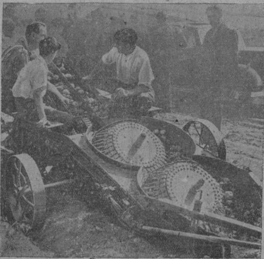
Esta máquina saca las patatas del suelo y las mete en los sacos. Consiste en dos partes: una, que saca las patatas de la tierra, y la otra, que las clasifica y las mete en sacos o en el remolque
