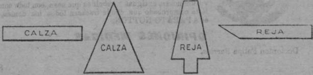
RÉCORTES Y PLETINAS PARA FABRICACIÓN DE HERRADURAS.
