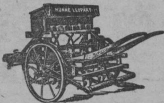
Las más favoritas para ser empleadas en esta Región puesto que además de ser sus rejas de acero flexibles y poderse ajustar para sembrar a distintos anchos, sirven a la vez para cultivador, ya que solo sacando dos tornillos desaparecen los tubos de acero flexibles conductores de la semilla y están convertidas ya para cultivar los terrenos que la misma haya sembrado.
