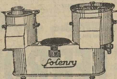
Peladora-cortadora de patatas. Capacidad, 200 Kg. hora. Motor 1 HP
