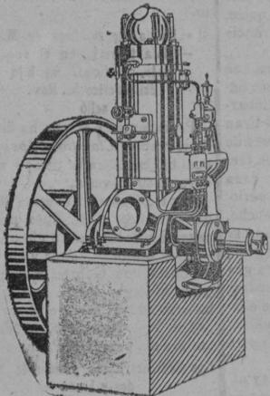
Motor para aceites pesados, sin válvulas sin magueto, adecuados para trilladoras
