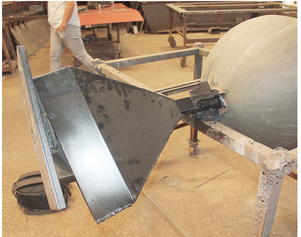
La base de la veleta ha sido fuertemente reforzada para garantizar su estabilidad.
