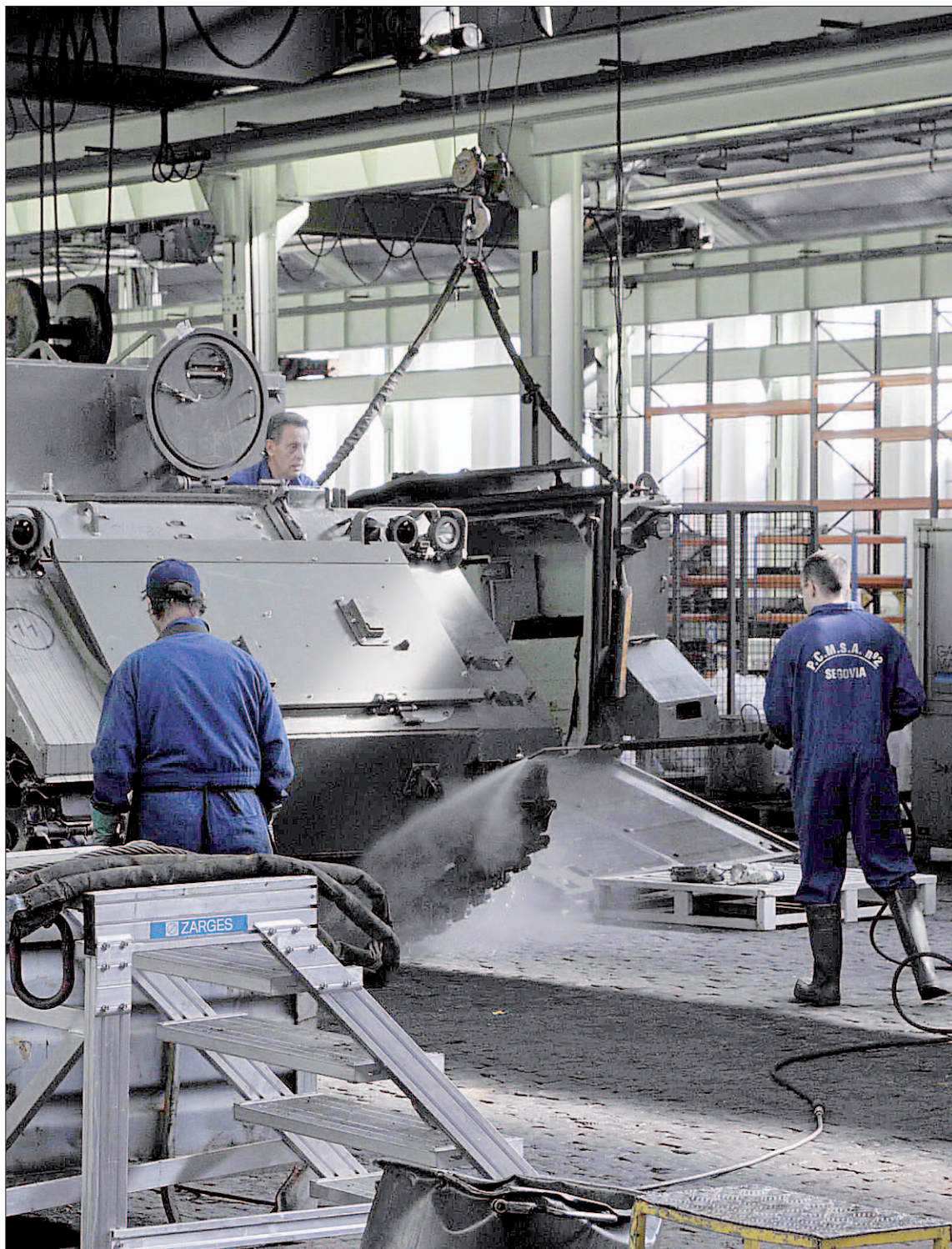
Los vehículos de transporte oruga acorazado son desmontados y montados para su mantenimiento en el centro./ A.B.
