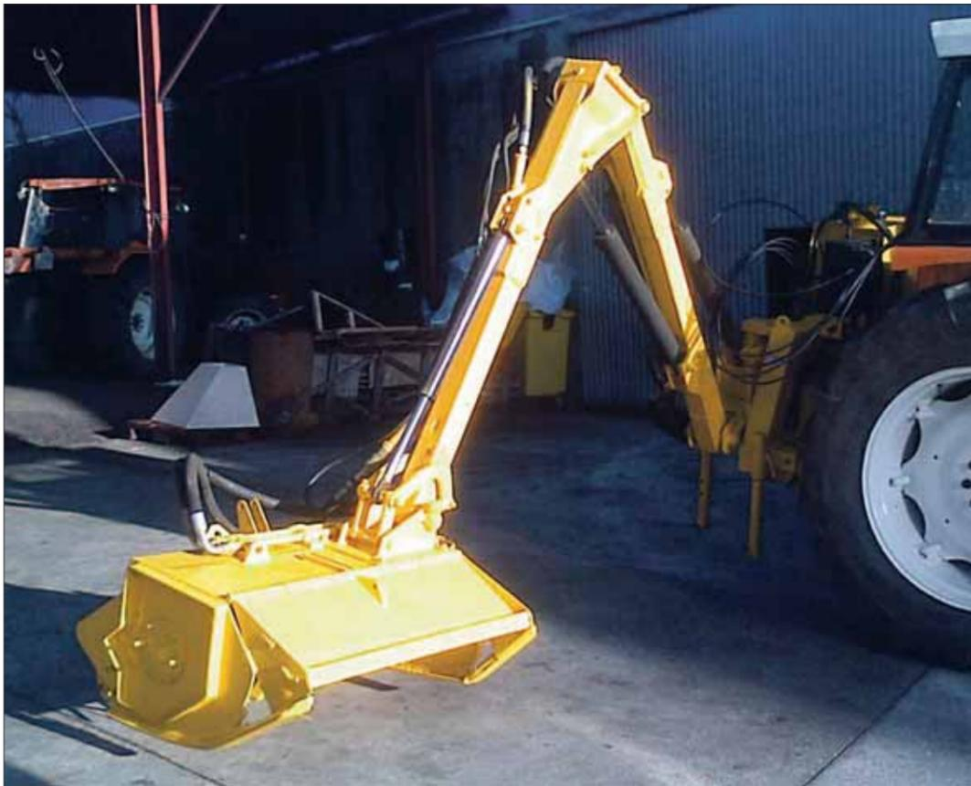
La nueva desbrozadora se remolca a un tractor y se extiende hasta 4,5 metros. / CHANTAL NÚÑEZ
