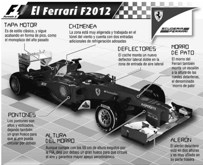
El nuevo monoplaza de Ferrari tiene mucho más trabajada la parte aerodinámica y ofrece soluciones novedosas, como el morro de pato, los nuevos pontones o la chimenea aligerada
