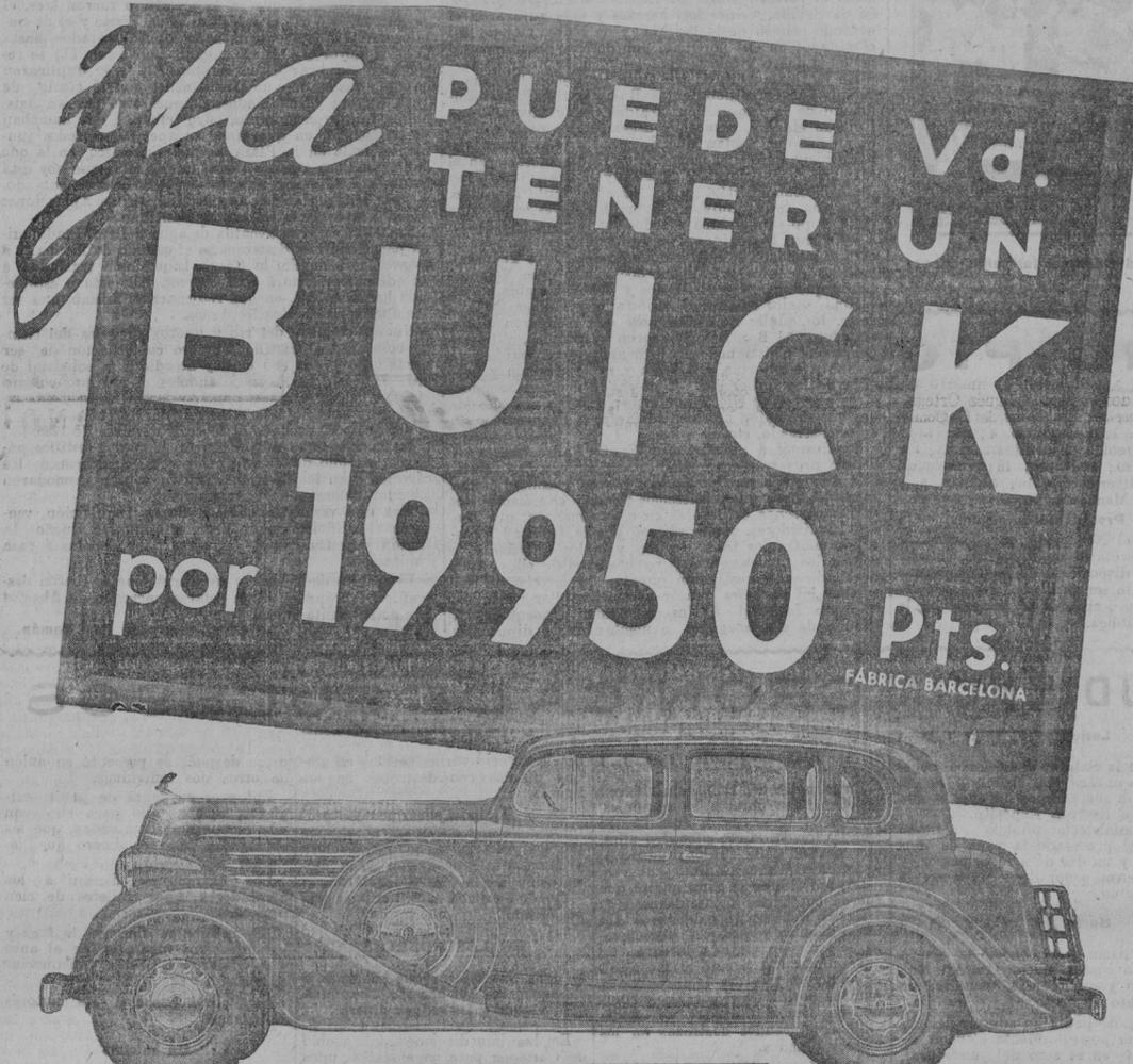
Principales características de BUICK «40» Motor 8 cil. en línea, válvulas en cabeza Potencia efectiva 93 HP. Ruedas con rodillas. Estabilizador de virajes. Carrocerías de madera y acero. Caja de cambios sincronizada con todas las marchas silenciosas.
