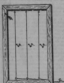
A.—Marco hecho con listones. B.—Hilos de coser. C.—El cable eléctrico que, al romperse cualquiera de los hilos, establece contacto y hace sonar el timbre de alarma. Total, dos duros.
