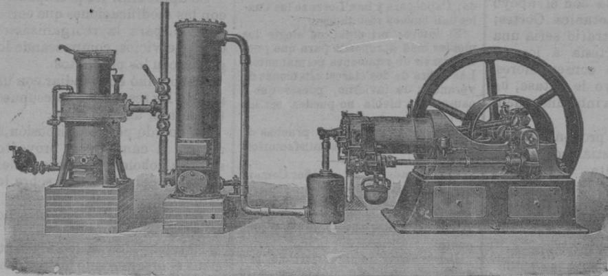
Motores de gas combinadas con fábrica de GAS POBRE del nuevo sistema por aspiración.
