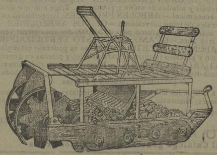
Mucho rendimiento, Único que trabaja con mies húmeda. Lleva cuatro cilindros que trabajan a diferentes velocidades. Cada eje va provisto de un engrasador automático. ES EL MEJOR TRILLO.
