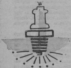
● Unas bujías con carbón, aceite o recalentadas, producen un consumo extra de combustible de hasta un 5%.
