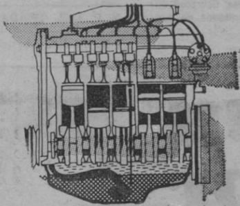
● Un exceso en el nivel de aceite en el cárter, se traduce en un aumento de consumo de combustible, al aumentar la resistencia del motor a girar.
