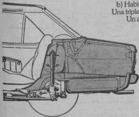
c) Estructura diferenciada en tres secciones (motor-habitáculo-maletero) con zonas de absorción de impactos.
