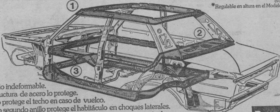
b) Habitáculo indeformable. Una triple estructura de acero lo protege. Un anillo protege el techo en caso de vuelco. Otro segundo anillo protege el habitáculo en choques laterales. Y un tercer anillo, unido a los travesaños principales, asegura una notable seguridad en la estructura.
