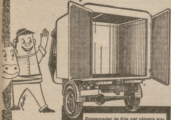
Conservador de frío por cámara aislante de corcho, interior forrado de cinc, con desagüe interior para hielo
