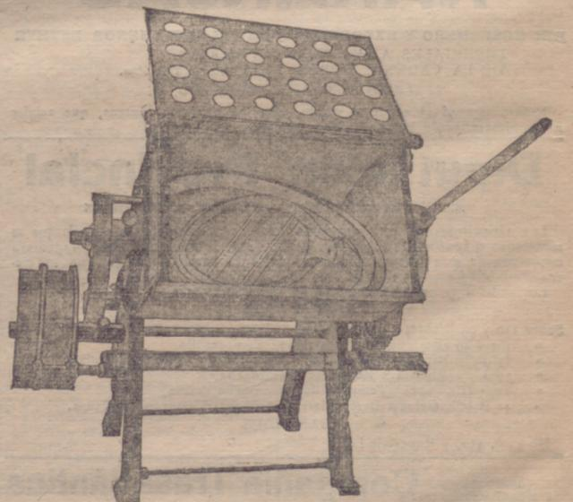
Esta Casa en su deseo de modernizar todas sus máquinas, presenta hoy nuevo modelo de ADOBADORA para carnes, con hélices dobles y movimiento reversible, con lo que se logra el trabajo más perfecto y la envuelta y mezcla completa de los elementos de fabricación.
