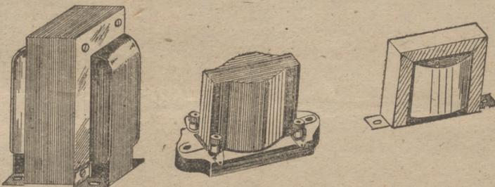
Fig. 34.—Representación típica de transformadores. A, transformador de poder; B, transformador de B. F.; C, transformador de altavoz
