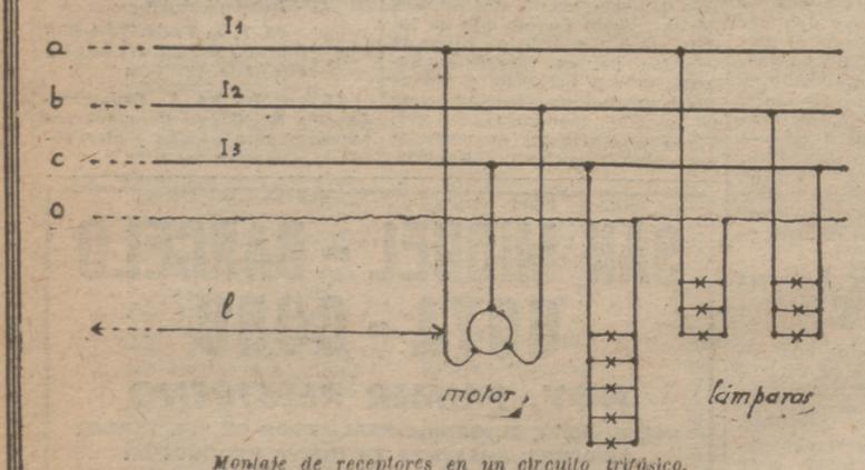
Montaje de receptores en un circuito trifásico.
