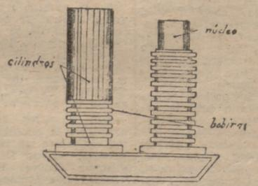
Detalle constructivo de un transformador monofásico.
