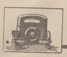
Chassis Renault Indeformable, descarsando sobre tres puntos de apoyo. Confort máximo en los asientos por una ballesta transversal articulado. Supresión del balanceo por la libertad de oscilación del eje trasero y por amortiguadores hidráulicos a doble efecto. Ninguna complicación ni piezas frágiles en el chassis. Dirección ultra-precisa.
