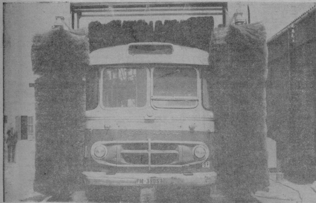
Uno de los autobuses de la Compañía de Tranvías de Palma, pasando bajo el recién inaugurado túnel de lavado automático. En la fotografía, los potentes rodillos proceden a limpiar los lados y la parte delantera del vehículo.
