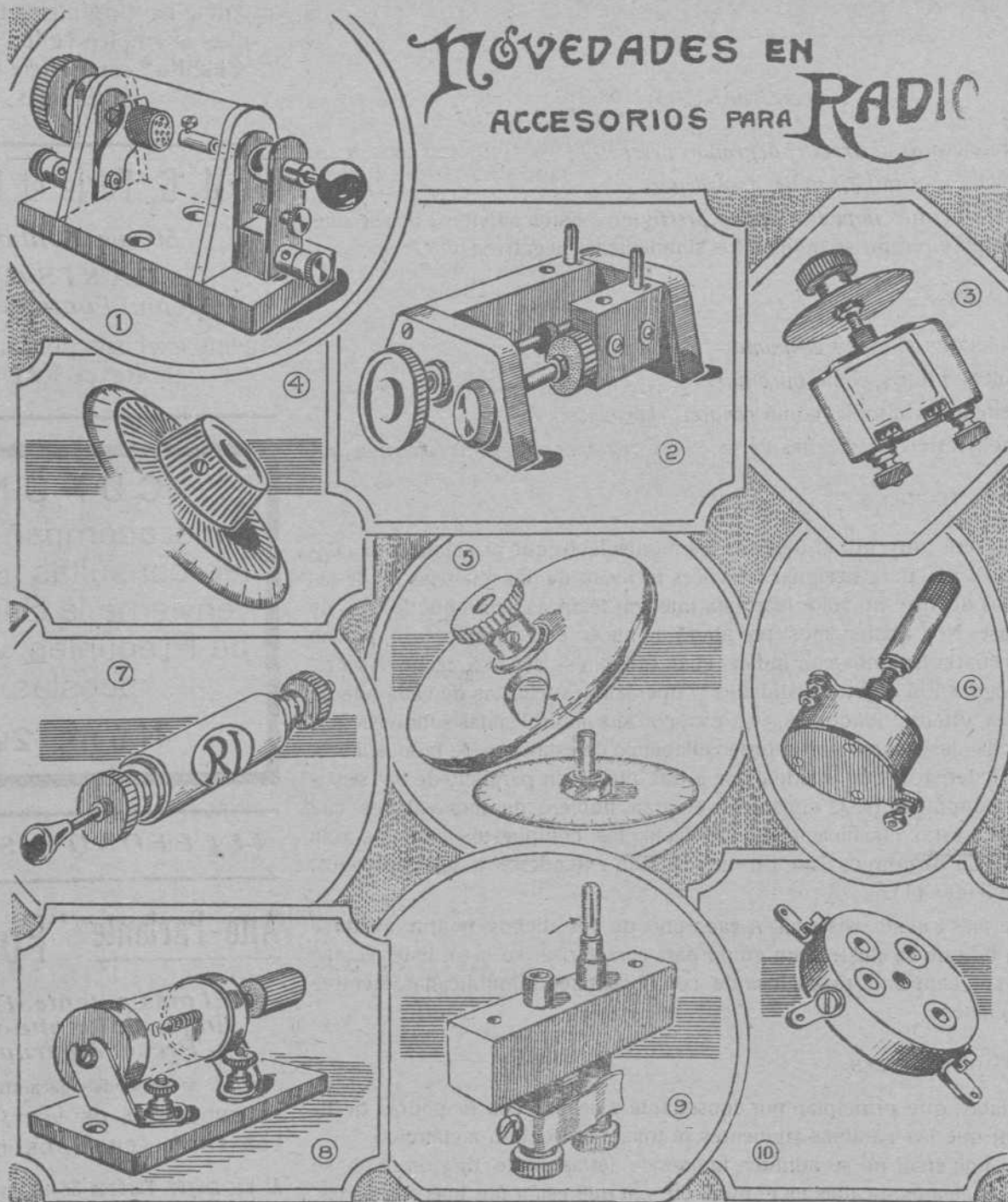
1.º Detector de cristal con cubierta de celuloide que lo preserva del polo.—2.º Soporte para bobinas de nido de abejas o duolaterales con movimiento graduado.—3.º Condensador de paso con maneta graduado.—4.º Novísimo dial graduado.—5.º Tapa de dial con ventanilla para leer la graduación.—6.º Resorte de contacto.—7.º Condensador fijo.—8.º Detector abierto para cristal.—9.º Enchufe para bobinas duolateral o nido de abejas.—10. Soporte cambiabile de lámpara para fijar en el panel.
