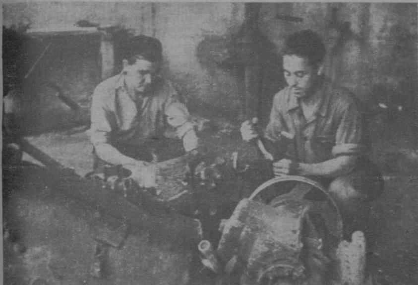
Para evitar el gasto de divisas, de los autos que se inutilizan, después de obtener de ellos el debido rendimiento, se extraen las piezas que pueden ser aprovechadas o reparadas para ser utilizadas en otros coches o motores, después de una escrupulosa clasificación.
