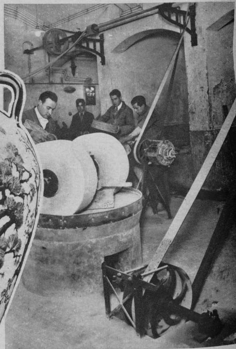
Sección de molturación de tierras y de preparación de colores
