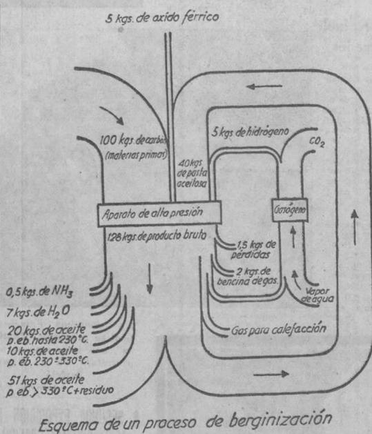
Esquema de un proceso de berginización
