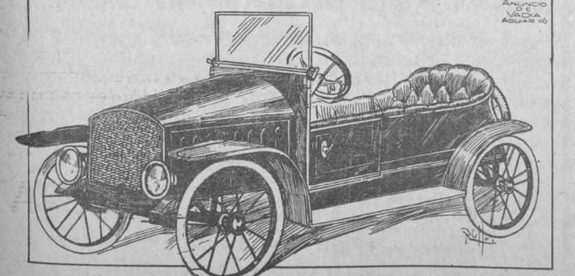
Con alumbrado eléctrico, bocina eléctrica, guardafangos cerrados, amplio estribo, freno de mano, parabrisas de cristal y cojines blandos, recubiertos de cuero. Gobierno, pedales, transmisión y todas las fricciones, montadas sobre cojinetes de acero. La transmisión es por cadenas. Lo mismo sirve para un niño de 4 años, que de 14, porque su asiento y pedales son ajustables al largo de las piernas.
