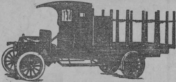
No. 500. Tipo Plataforma con estacas móviles.
