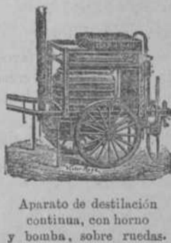
Aparato de destilación continua por vapor. Da sin reposo espíritus de 94 grados.
