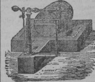
Puente báscula vinícola.—Nuevo sistema de caja metálica, colocándose á flor de tierra para facilitar el pesado de los toneles colocados encima en cualquier sentido.
