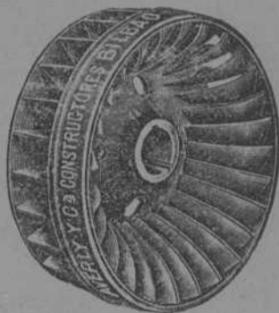
Rueda turbina «Francis»
