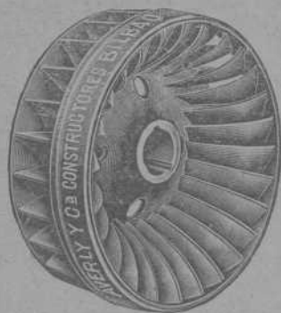
Rueda turbina «Francis»
