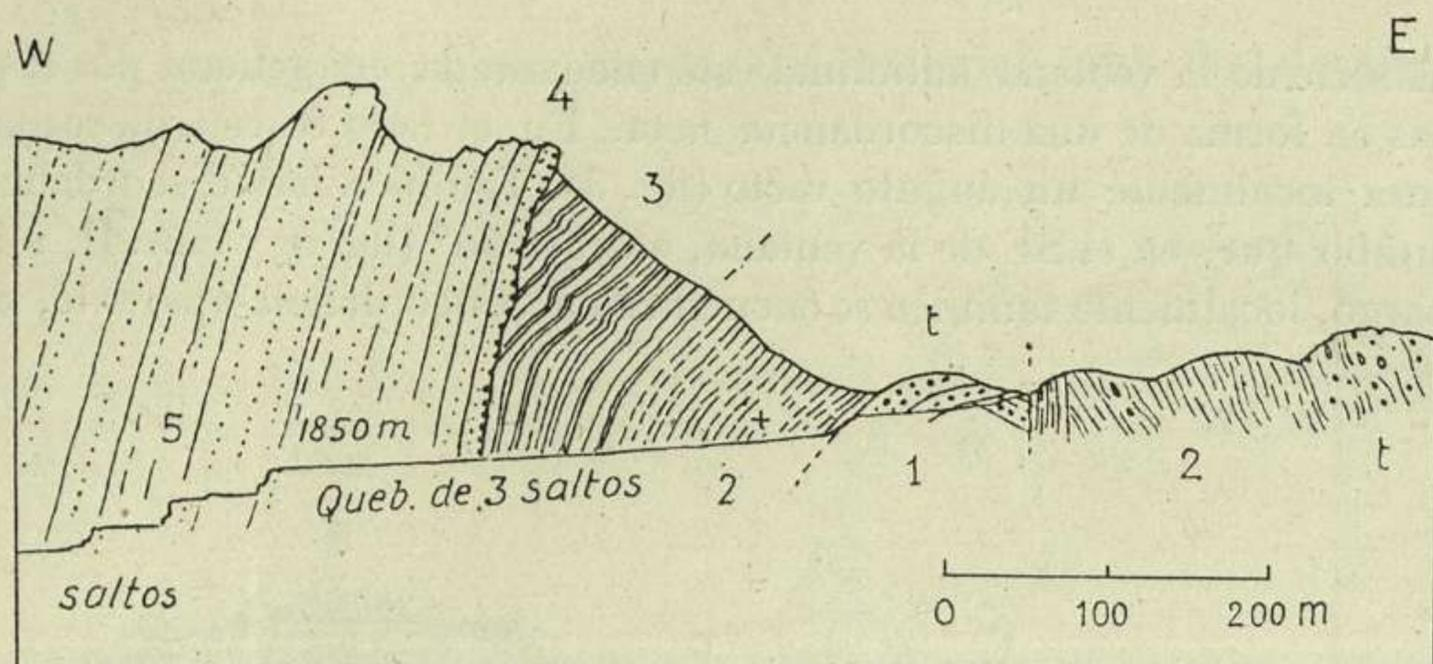
Fig. 5. — Discordancia de la serie II sobre I en el NW de la « ventana », parte alta de la Quebrada de 3 Saltos. 1, Tilita anticlinal; 2, Esquistos verduscos con fósiles (+) y tilita (t); 3, Bancos finos de arenisca arcillosa con rastros vermiformes; 4, Banco de arenisca con  $\frac{1}{2}$  m de conglomerado basal; 5, Areniscas duras (Paganzo II). (Compárese lám. V, 1).
