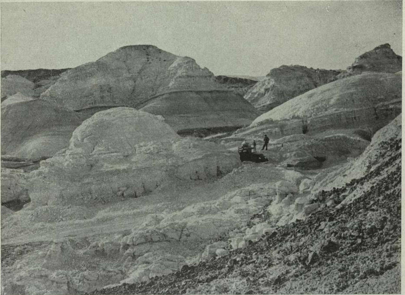
1. Mina de Bentonita, NE de Barreal (véase figs. 1 y 9 del texto). Triásico con tobas blancas-verduscas-amarillas. La parte explotada de 3-5 m se reconoce al lado del camión. La inclinación hacia la izquierda corresponde a la del eje anticlinal hacia el norte.
