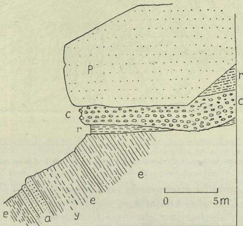
Fig. 7. — Detalle sobre la Esquina Gris, parte alta de la figura 6 y de la lám. III, 2; e, arcillas verdes con fósiles marinos carbónicos; y, lánimas de yeso; a, bancos de areniscas; r, arcilla roja; c, conglomerado; p, pórfito cuarcífero.
