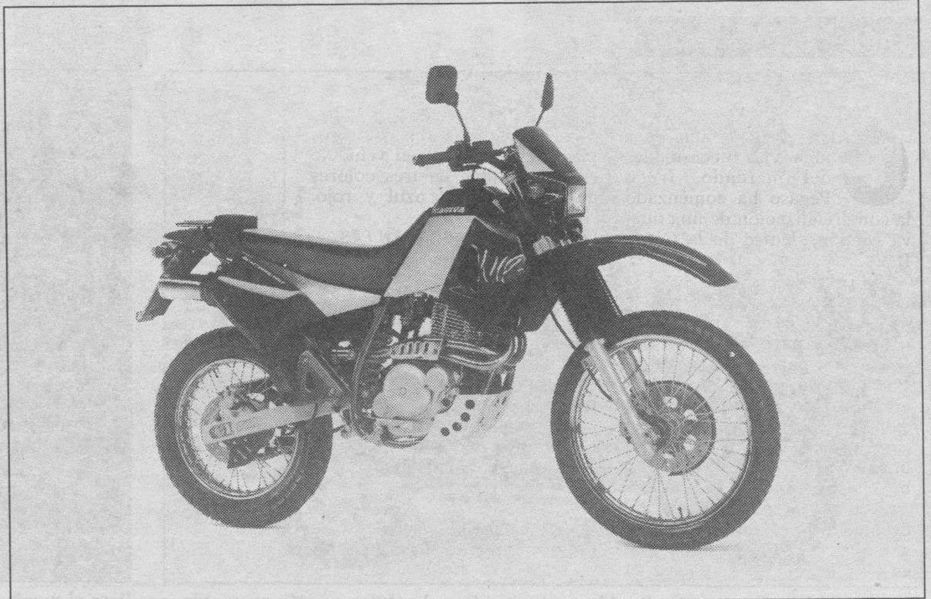
Aspecto ligero para la trail W-12 de Cagiva, una monocilíndrica de 4 tiempos
