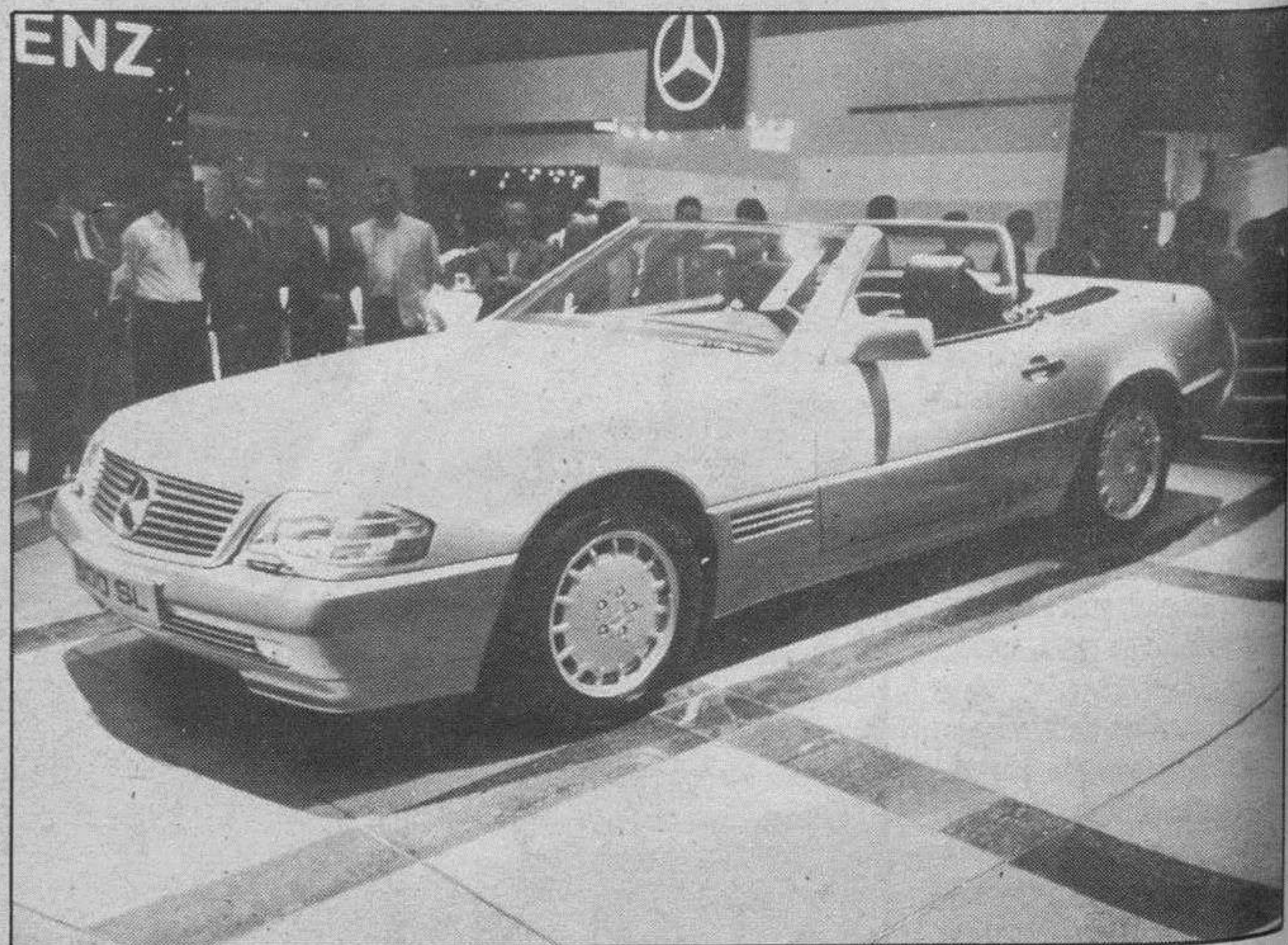
Mercedes 500 SL. — Fue el más admirado de la marca alemana, tanto por su línea como por sus sistemas de seguridad (Airbag y arco anti vuelco). Sus 326 CV le proporcionan una velocidad de 280 Km/h. Su precio superará los diez millones de pesetas.
