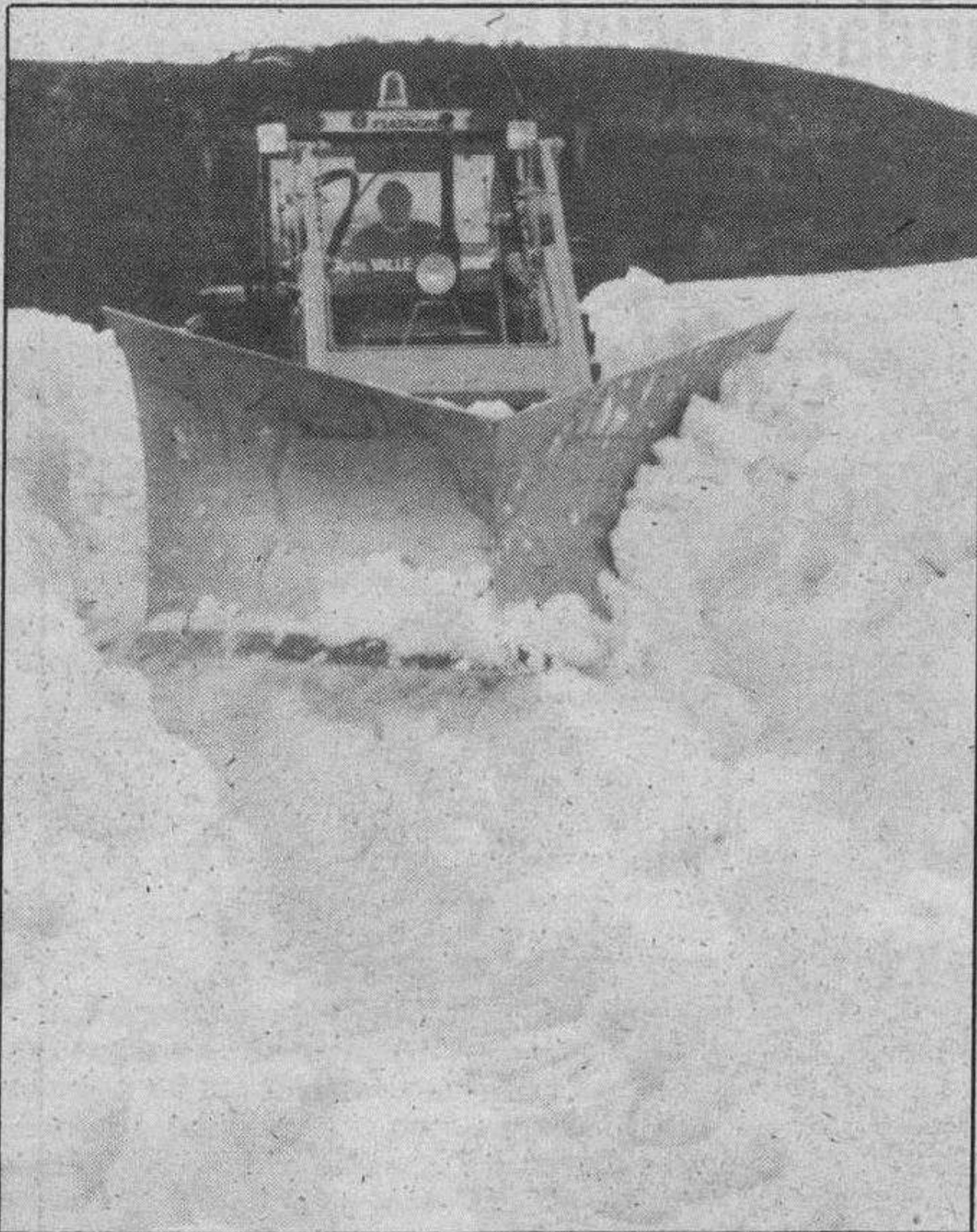
Actuación durante las pasadas nevadas del tractor del Ayuntamiento de Valle de Valdebezana con la cuña quitanieves, cuña con la que la Diputación dotará a los Ayuntamientos que lo soliciten.
