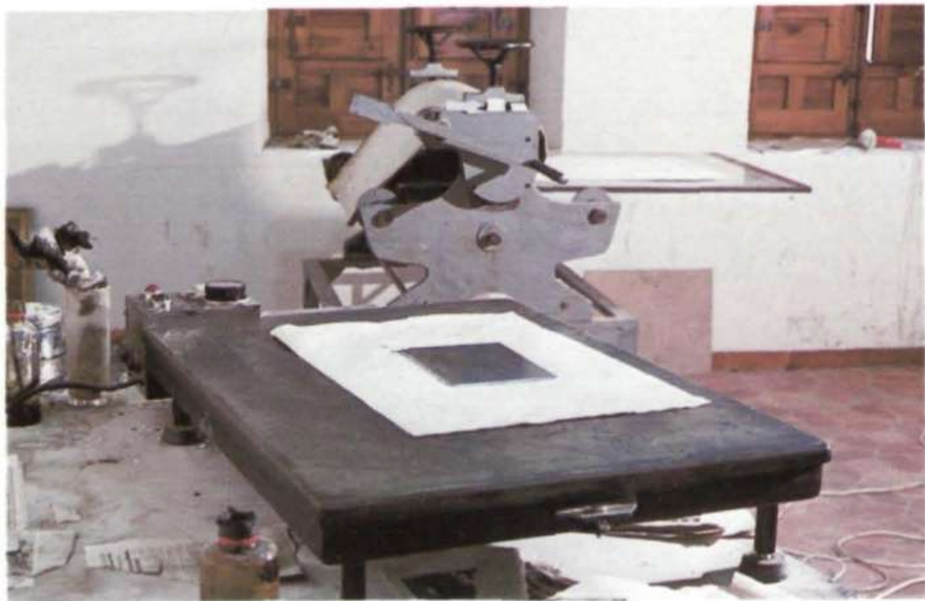
2. Sala de entintado y estampación. Plancha-horno y tórculo.
