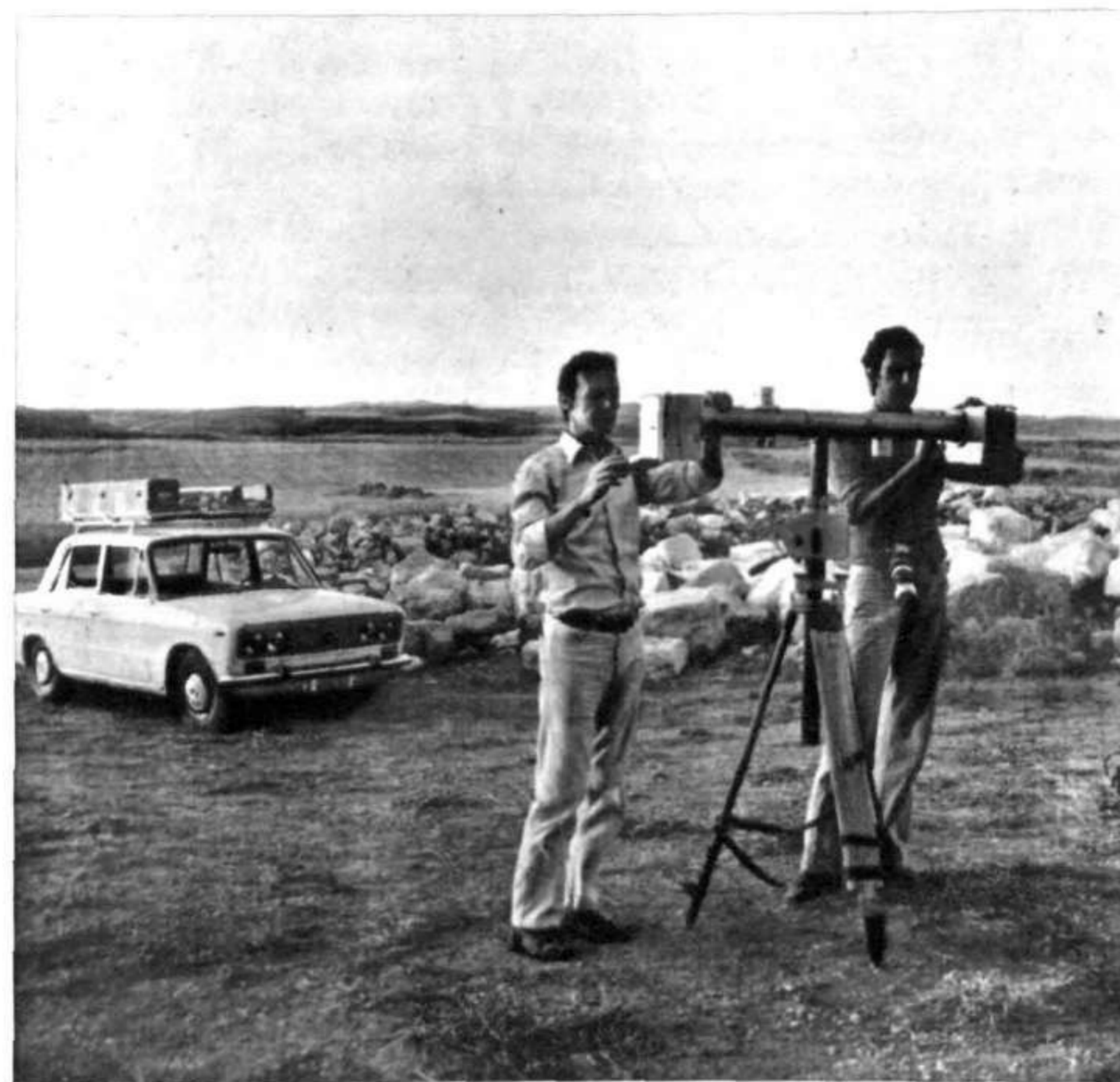
COLOCACION DE LAS PLACAS EN LA BICAMARA.
