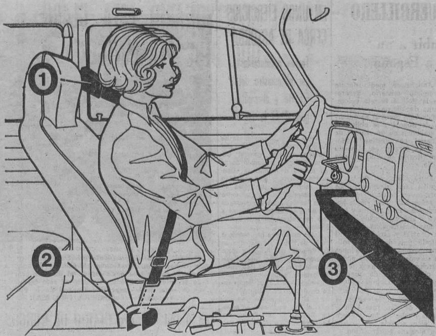
Este nuevo cinturón de seguridad para el coche se coloca automáticamente tras cerrar la puerta. Se trata de un sistema de sujeción pasivo desarrollado por el Volkswagenwerk de Alemania. Los tres elementos que le caracterizan son: la combinación de cerradura (1) en la puerta y su bastidor, el automático de enrollamiento (2), y el protector de rodillas (3). En caso de frenazo o choque se bloquea el automático. Los movimientos quedan totalmente libres durante el viaje. — (Foto FIEL).
