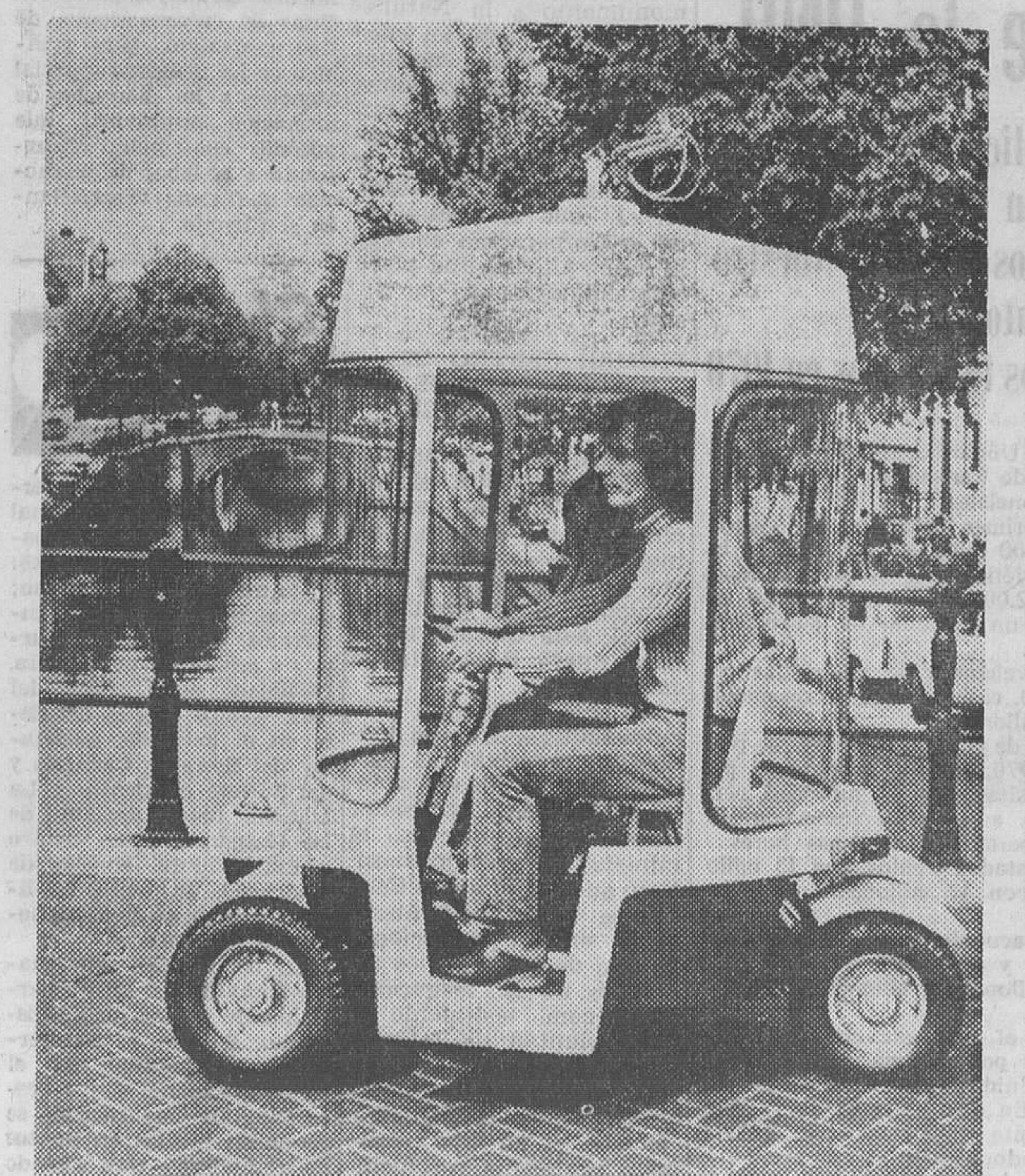
El primer "Witkar" (coche blanco) ha hecho una demostración por las calles de Amsterdam, en Holanda. Se trata de un vehículo ideado por el joven ex-provo Luud Schimmelpenninck y por el que se han interesado las autoridades de la ciudad. Es un coche eléctrico, con baterías, que no proporciona contaminación a la atmósfera. Se intenta reducir con él el denso tráfico del centro de Amsterdam. Parece que se piensa construir un buen número de ellos, que se podrán alquilar en determinados puntos y dejar después de la misma manera. En esta foto vemos al "Witkar" conducido por su inventor por las calles de Amsterdam. — (Foto Fiel)
