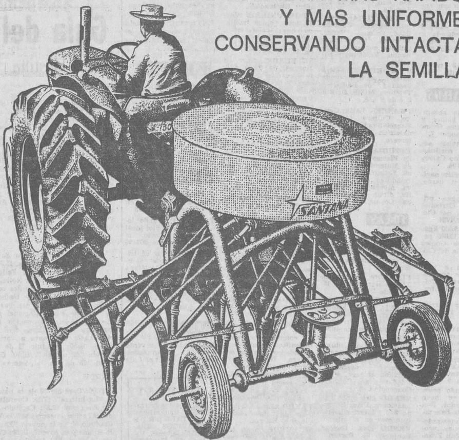
El sistema centrífugo de la sembradora SANTANA permite que la semilla se deposite uniformemente asegurando una perfecta distribución. La sembradora centrífuga SANTANA está especialmente concebida para sembrar toda clase de semillas. **SIEMBRE MEJOR Y MAS DEPRISA Y AHORRE SEMILLA CON LA SEMBRADORA CENTRIFUGA UNIVERSAL, SANTANA S-16**
